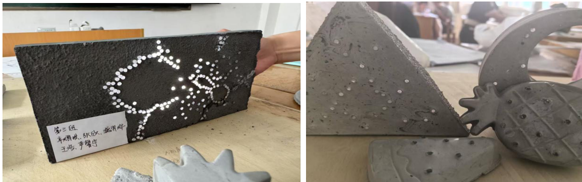
图1. 创新实验透光混凝土作品
