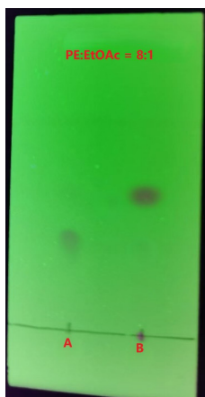
图7. 热化学合成反应5小时TLC情况 (A: 苯频哪醇1, B: 反应体系)
