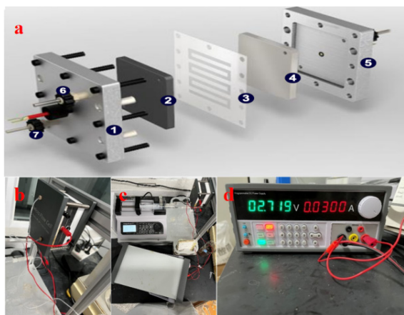
图4. 流动电化学反应器主要部件
