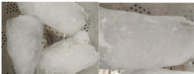
图3. 这封口后结冰的冰体内的大蒸气泡现象
