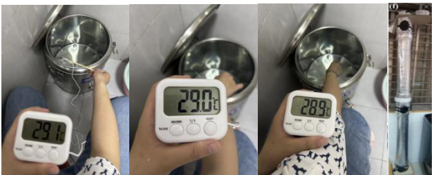
图7. 保温茶水桶和2米管水的蒸发引起上热下冷效应实验（从左到右a、b、c、d）
