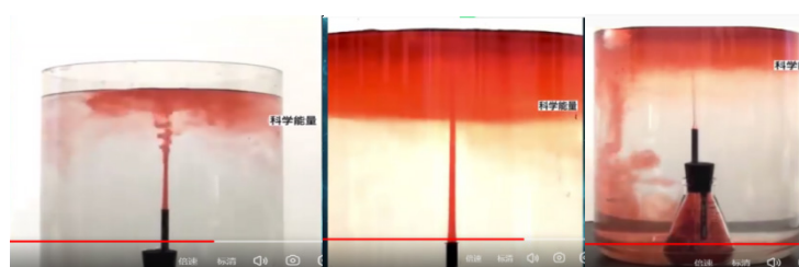
图2. 对流造成的烟囱和瀑布实验（从左到右a、b、c）
