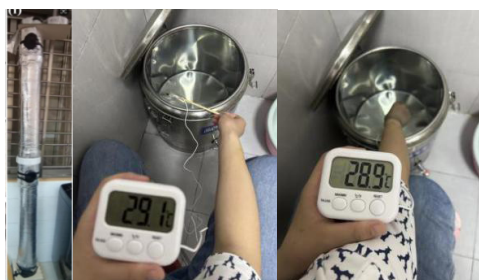
图1.2米管水和保温茶水桶的蒸发引起上热下冷效应实验
