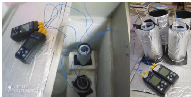
图3.玻璃杯内上热下冷的水在冰柜内开口蒸发引起上下同步降温的实验
