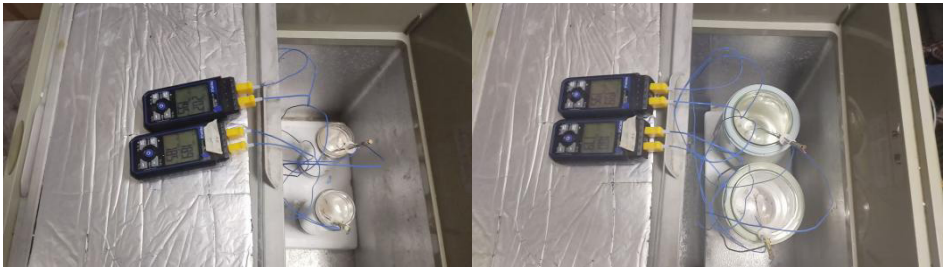
图2.酒精在冰柜内的蒸发引起上热下冷效应的实验装备
