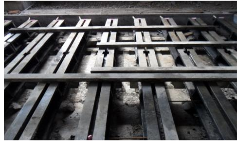
图4 机床模具在T型槽铁中的安装现场
