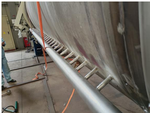
图10 镁基固态储氢罐集合管拔口和换热管对接焊缝
