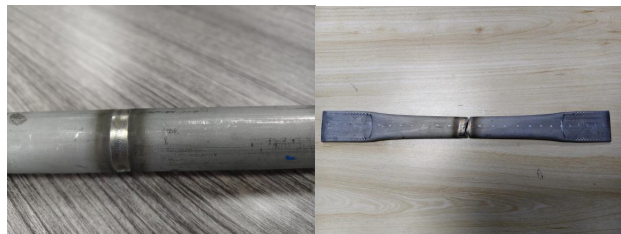
图3 \Phi 25\text{mm} \times 2\text{mm} 不锈钢管对接焊缝外观
