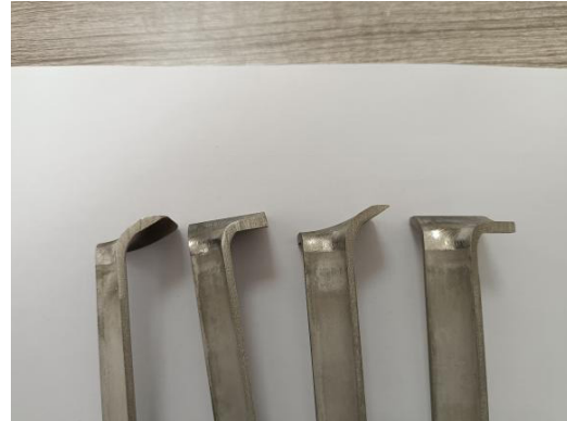
图9 集合管拔口焊缝熔合线检查
