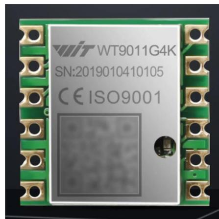
图3. 维特智能 WT9011G4K 陀螺仪
